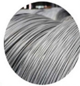
3.0mm Wire Inside 内含钢丝 Keep Shape 定型
